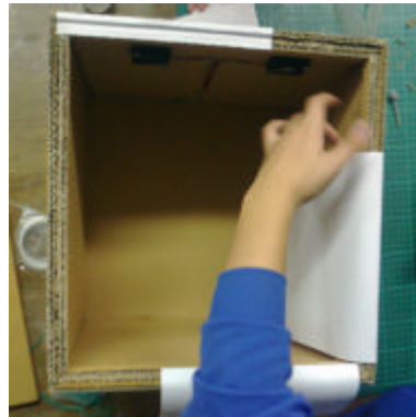
圖 4-6 模型封孔，增加氣密性
