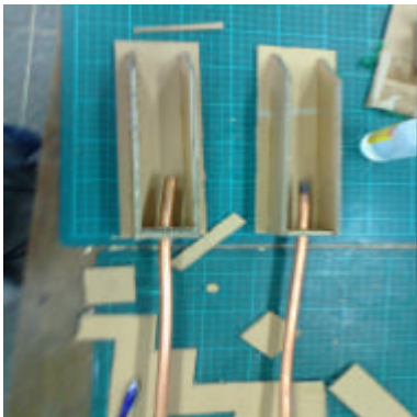
圖 4-11 組裝氣室並接上銅管
